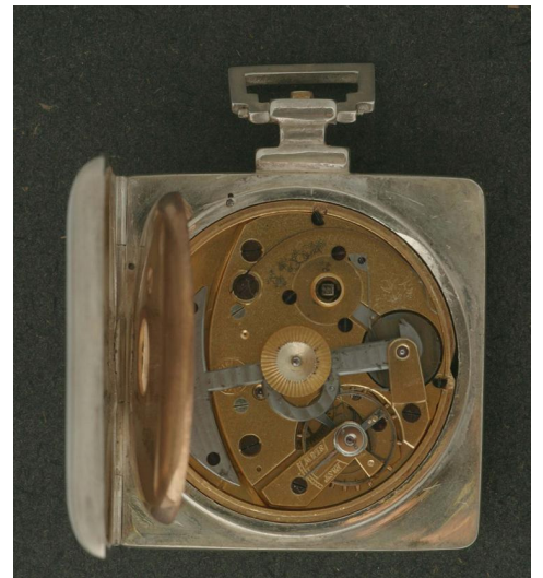
Silberne Taschenuhr mit automatischem Aufzug "Perpetual Loehr Patent" Nr. 5000, um 1879 Inventarnummer K-0728
